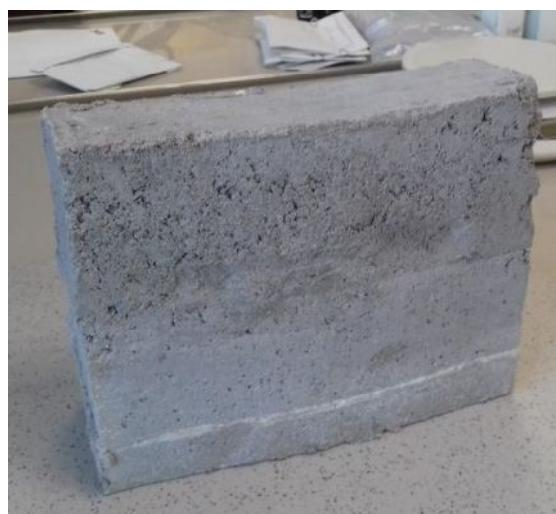
Рис. 1. Образец бетона, полученный по технологии трехмерной печати
